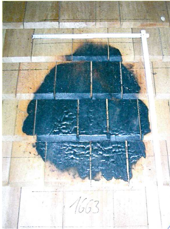
Probedach #2 nach der Brandprüfung Roof sample #2 after flammability test
