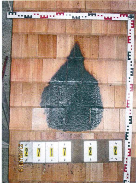
Probedach #6 nach der Brandprüfung Roof sample #6 after flammability test
