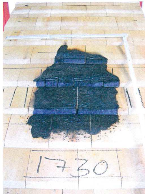
Probedach #4 nach der Brandprüfung Roof sample #4 after flammability test
