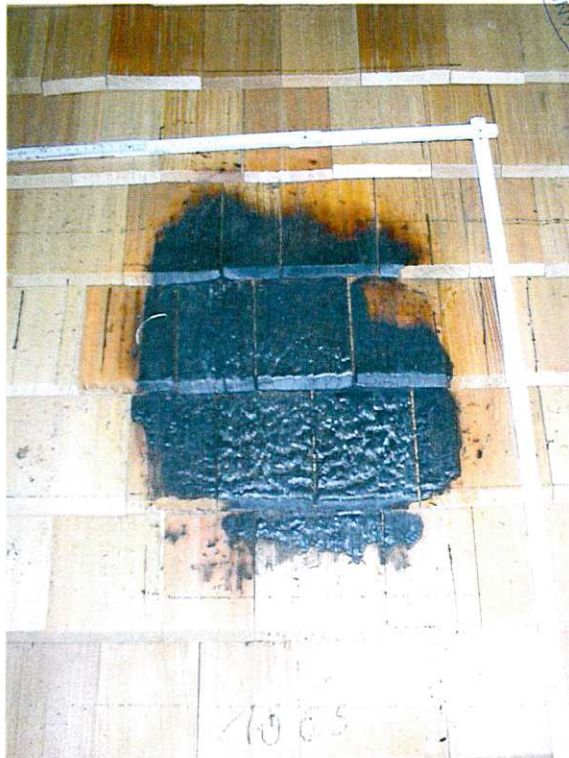
Probedach #2 nach der Brandprüfung Roof sample #2 after flammability test
