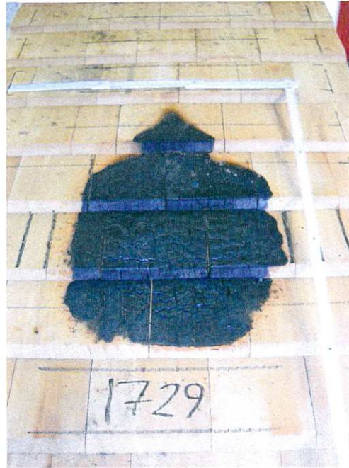
Probedach #4 nach der Brandprüfung Roof sample #4 after flammability test
